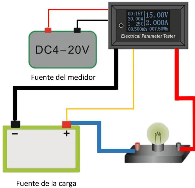
Cuando se usa la fuente de la carga para alimentar al medidor
