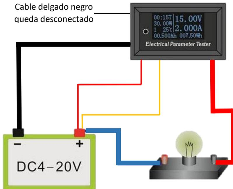
Cuando se usa la fuente de la carga para alimentar al medidor y es mayor a 20V
